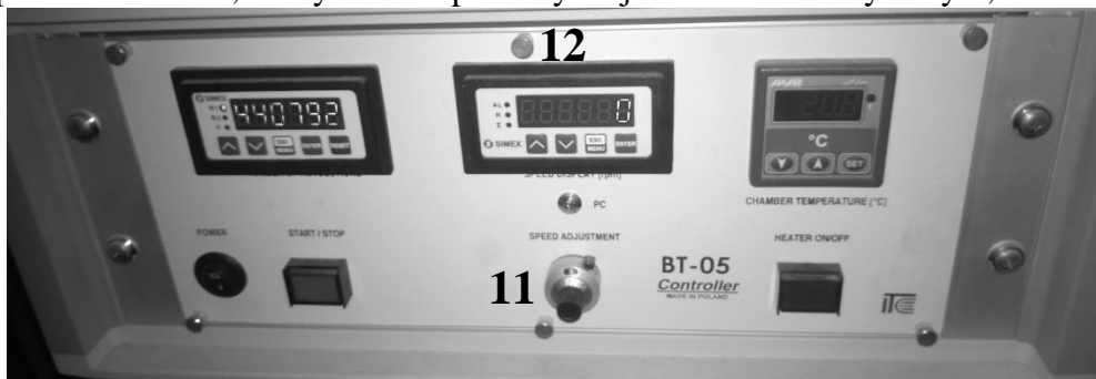
Rys. 6. Sterownik BT-05. 11- pokrętko regulacji prędkości obrotowej wrzeciona; 12- ekran odczytu prędkości obrotowej
