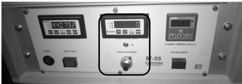
Rys.10. Panel przedni sterownika BT-05 z zaznaczonym pokrętkiem oraz wyświetlaczem do regulacji i odczytu prędkości obrotowej wrzeciona.
