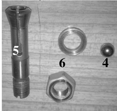
Rys. 3. Elementy układu współpracującego. 4- przeciw próbka (kulka); 5- tulejka zaciskowa do mocowania kulki; 6- podkładka i nakrętka
