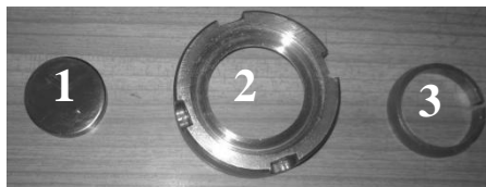
Rys.1. (1) próbka (tarcza); (2) nakrętka; (3) pierścień zaciskowy
