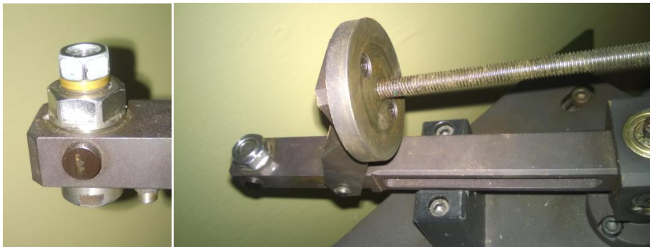
Rys.4. Końcówka ramienia obciążającego wraz z zamocowaną przeciw próbką
