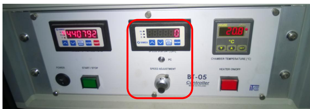
Rys.10. Panel przedni sterownika BT-05 z zaznaczonym pokrętle oraz wyświetlaczem do regulacji i odczytu prędkości obrotowej wrzeciona.
