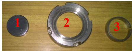
Rys.1. (1) próbka (tarcza); (2) nakrętka; (3) pierścień zaciskowy
