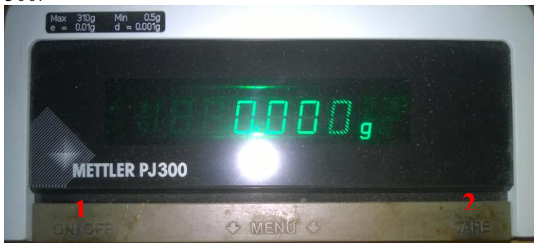
Rys. 1. Panel kontrolny wagi.
