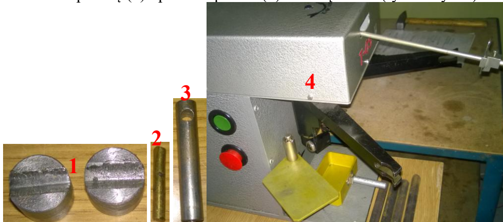
Rys.1. Od lewej: (1) przysmy, (2) sworznień mosiężny,(3) próbka, tester T-09 ze zdemontowanym układem obciążającym.
